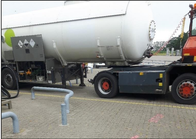
Figur 46 Eksempel på påfyldningsanlæg på tankbil. Foto: WH-PlanAction
