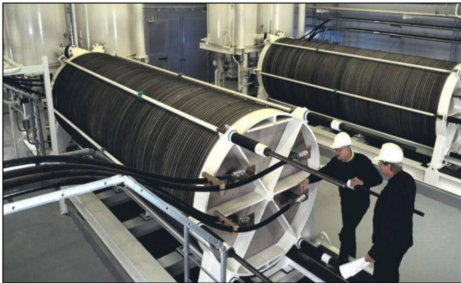
Figur 12 Eksempel på elektrolyseenhed. Kilde: ukendt
