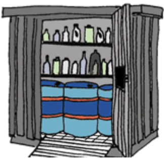
Figur 3 Udendørs opbevaring i container med dobbelt bund.
