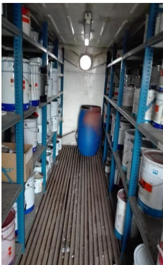
Malingsstøv opbevares sammen med ny maling i lukket container med dobbeltbund.
