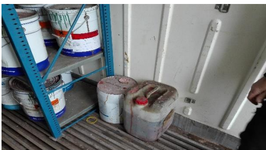
Flydende farligt affald i lukket container med dobbeltbund.
