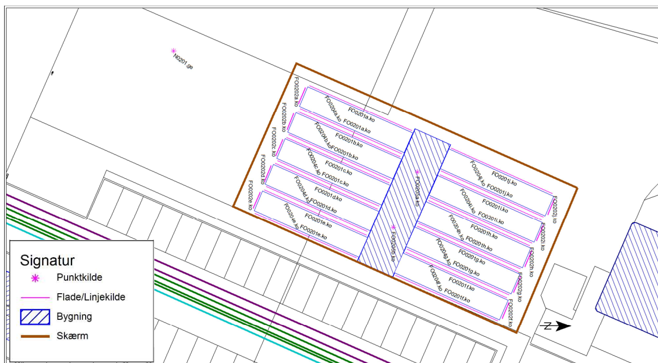
Figur 1. Placering af nyt ventilationsanlæg
