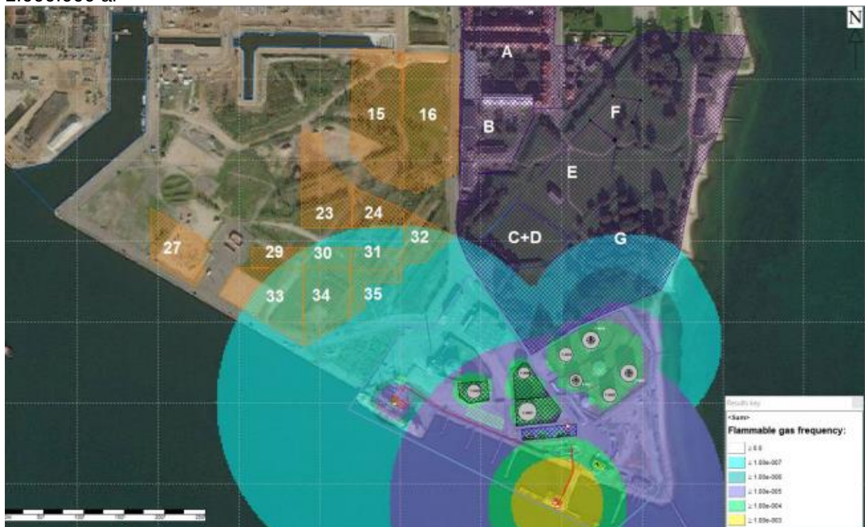
Figur 3 Maksimum konsekvensafstand for havneterminalen uden barrierer og dermed den maksimale rækkevidde i værste fald
