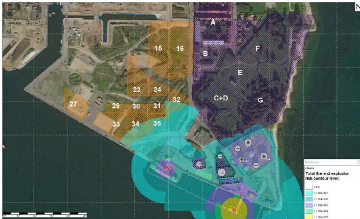
Figur 4 Iso-risiko kurver for havneterminalen, viser risikoen for en given udbredelse, hvor de forskellige barrierer er bygget ind i og dermed begrænser det påvirkede område
