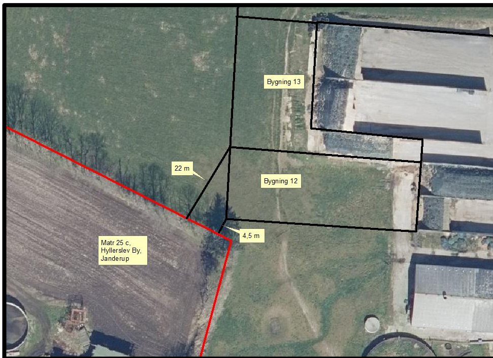
Figur 4 Manglende overholdelse af afstandskravet på 30 m til naboskel
