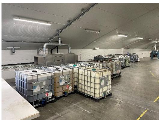
Pallettankene med indhold på fastbelægning uden afløb.
