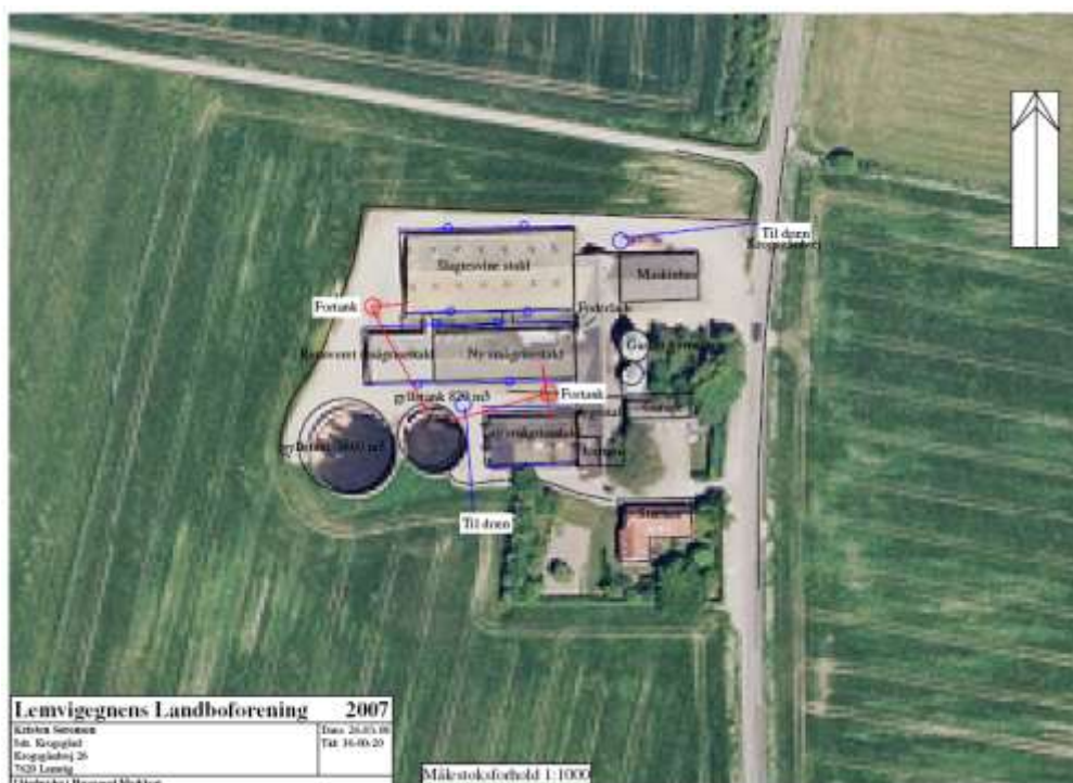
Figur 4: Afledning af tag- og overfladevand.
