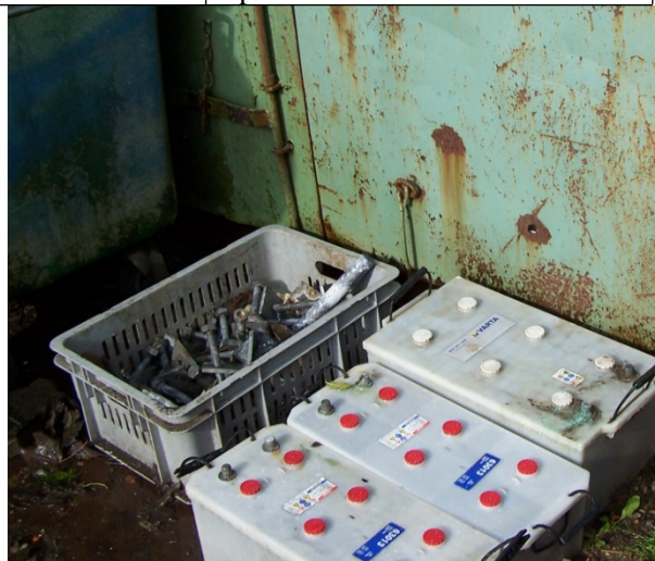
Akkumulatorer placeret direkte på fugtig jordbund
