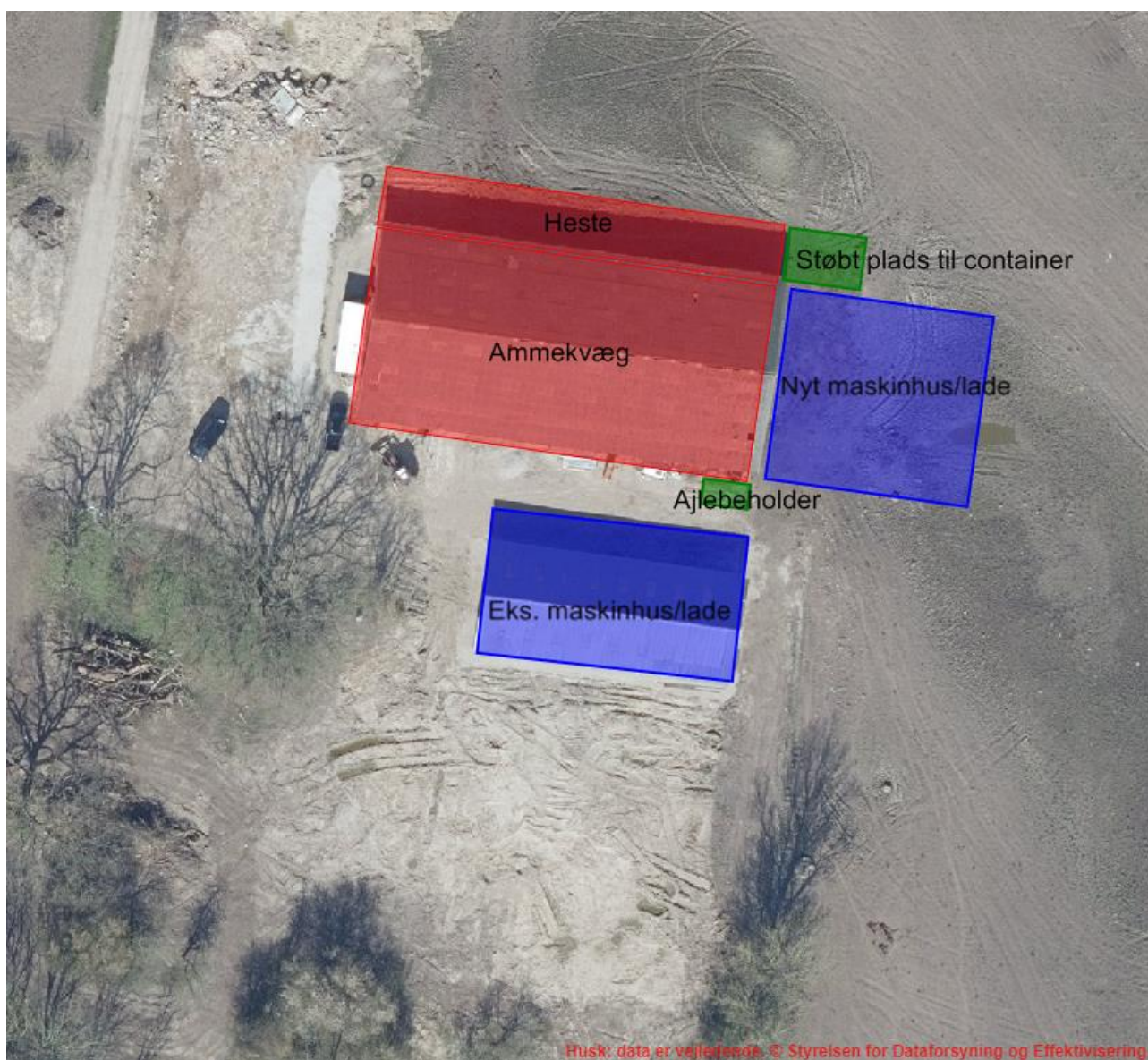
Figur 1 – Anlægstegning. Staldafsnit markeret med rød, støbt plads til container samt ajlebeholder markeret med grøn og maskinhuse med blå.
