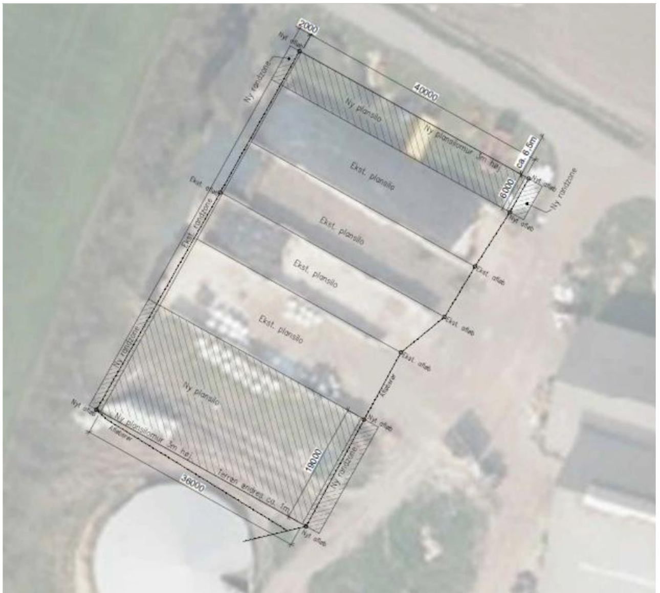
Figur 9 Afløb fra plansilo efter etablering af nyt silo
