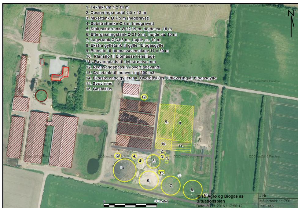
Indretning af biogasanlægget
