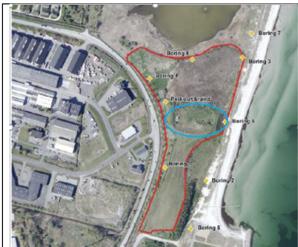
Fig. 1 Blå ring markerer området, som manglede slutafdækning, jf. tilsyn december 2019.
