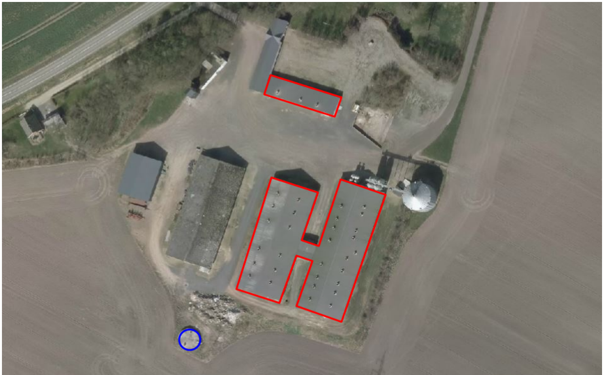
Luffoto: Ørsøvej 140 i 2017 med stalde (rød) og opbevaringsanlæg for husdyrgødning (blå) som indtegnet i tillægget til miljøgodkendelsen.
