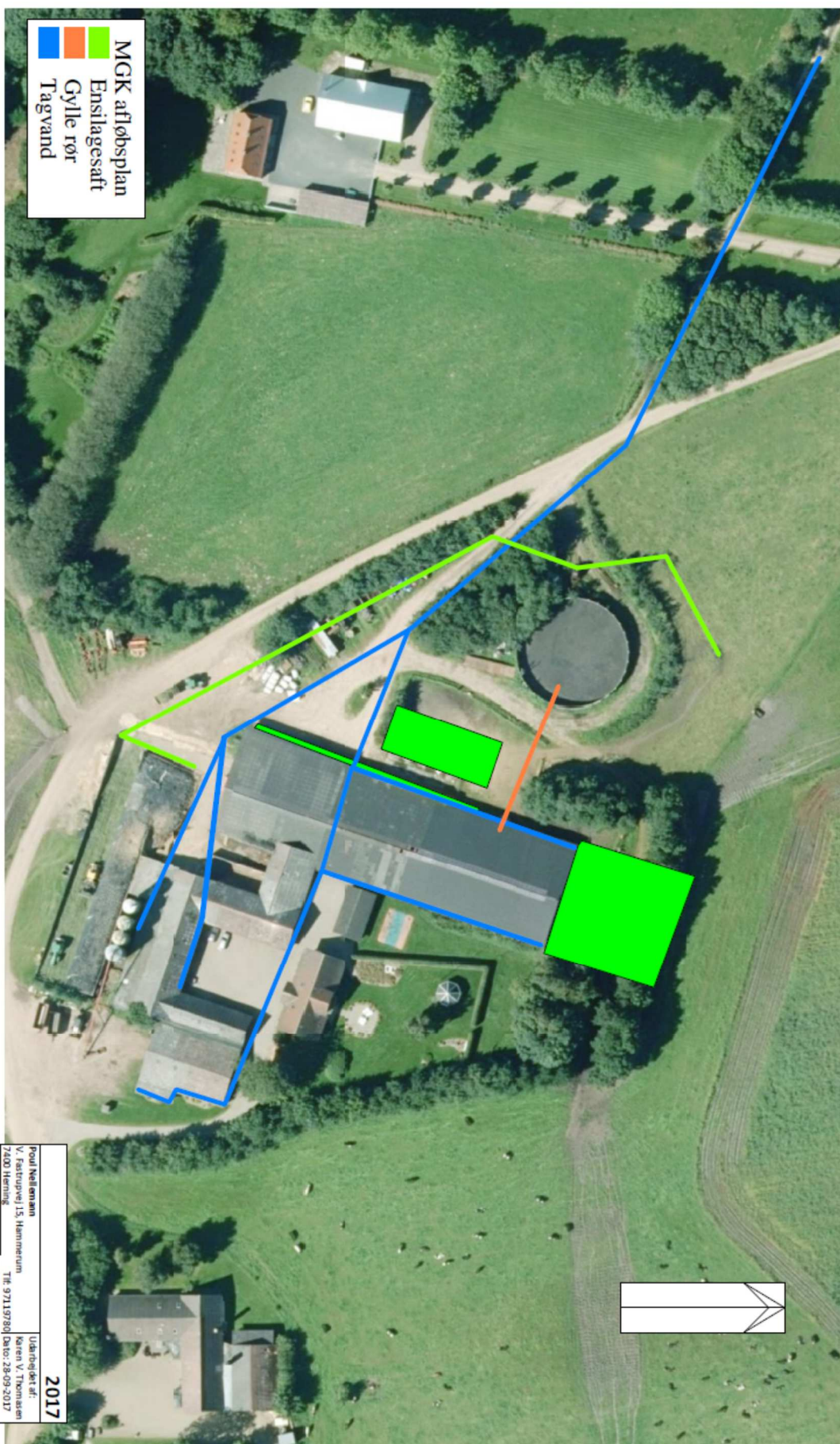
Bilag 2: Oversigt over ejendommens afløbsforhold
