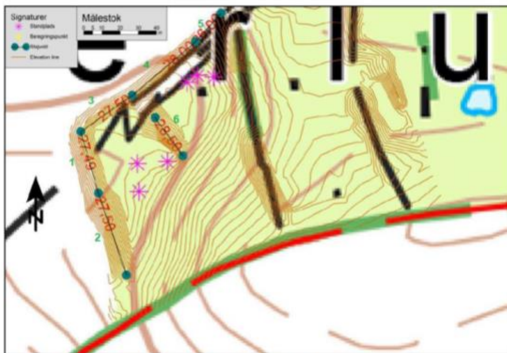
Figur 3: Angivelse af støjvolde, hvor de røde tal angiver nødvendige voldhøjder (topkoter) og de grønne prikker angiver, hvor fra og til denne topkote skal opfyldes. De grønne tal angiver voldnummer.
