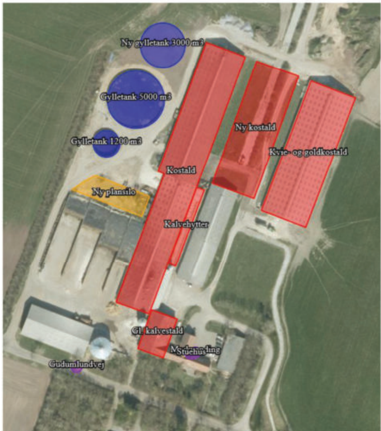
Bygninger på ejendommen efter udvidelse
