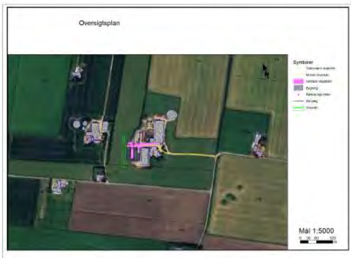
Figur 7, Støjvold markeret med grøn streg, 6,7 m høj 120 m lang.
