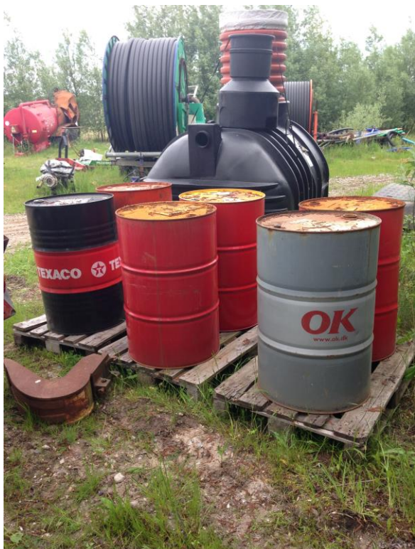
Tønder med rester af diesel m.m. var placeret udendørs uden sikring. Tønderne vil blive fjernet.
