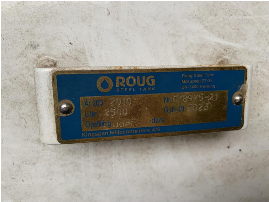
Mærkeplade tank til traktordiesel, 2500 l tank, årgang 2010.
