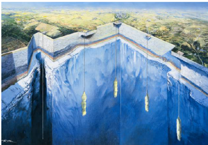
Figur 5.2 Skematisk fremstilling af Ll. Torup gaslager
