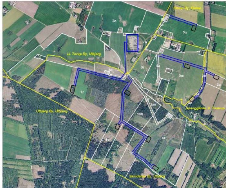
Figur 7.3 Ll. Torup gaslager med markering af 9 mulige, nye kavernepladser og udvidelse af behandlingsanlægget. Blå markeringer er nye kaverne, hvide markeringer er eksisterende kaverne og ledningskorridorer.
