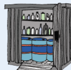
Figur 2: Udendørs opbevaring i container med dobbelt bund.
