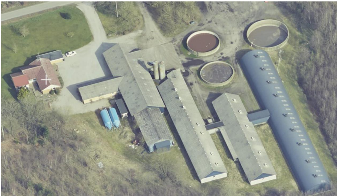
Figur 3 - Rundbuehal og eksisterende stalde forbundet med servicegang.
