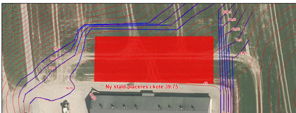
Figur 2. Koteplan for placering af den nye stald. Røde kurver angiver det nuværende terræn, blå kurver angiver terrænet efter etablering af den nye stald.
