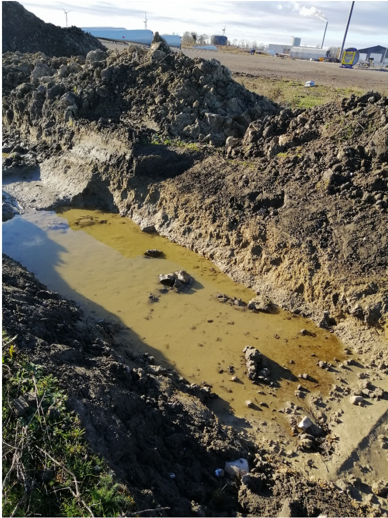
Figur 1: billede af det hul til pejling af grundvand, der ligger nordligst på projektområdet (se kortoversigt side 7).
