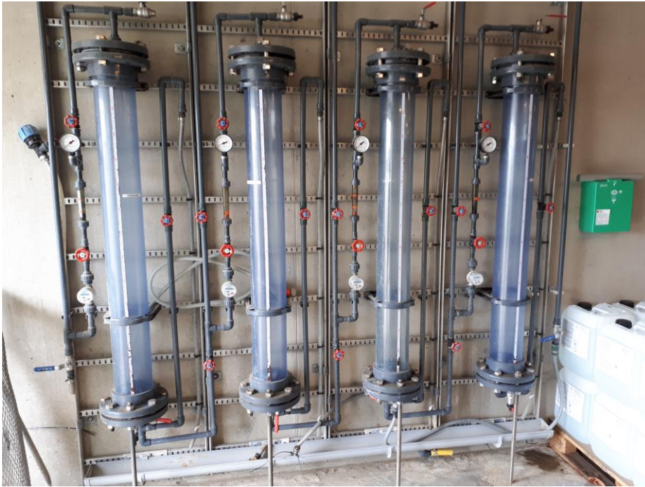
Kulfilter-pilotanlæg på 22 liter. Her kunne bl.a. konstateres slam i filterne under forsøgene.
