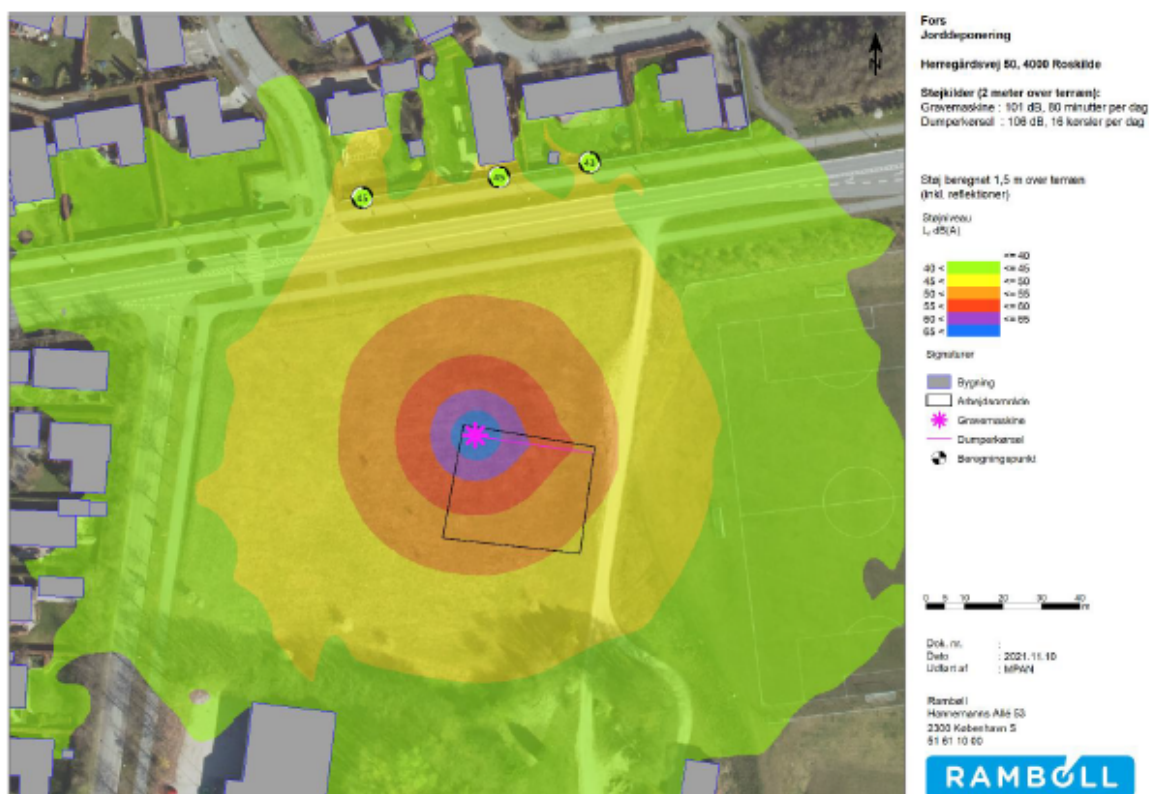
Figur 2 Driftsfase. Gravemaskine placeret tættest muligt boliger uden støjafsikring. På denne afstand til boliger kan arbejdet udføres i maksimalt 80 minutter per dag uden overskridelse af grænseværdien på 45 dB.
