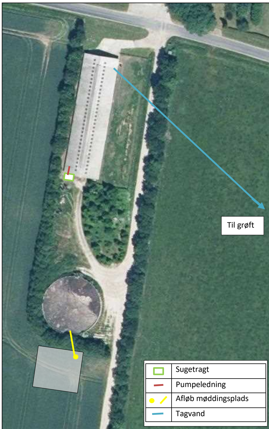
Figur 6. Afløbsplan for den sydlige del af staldanlægget.
