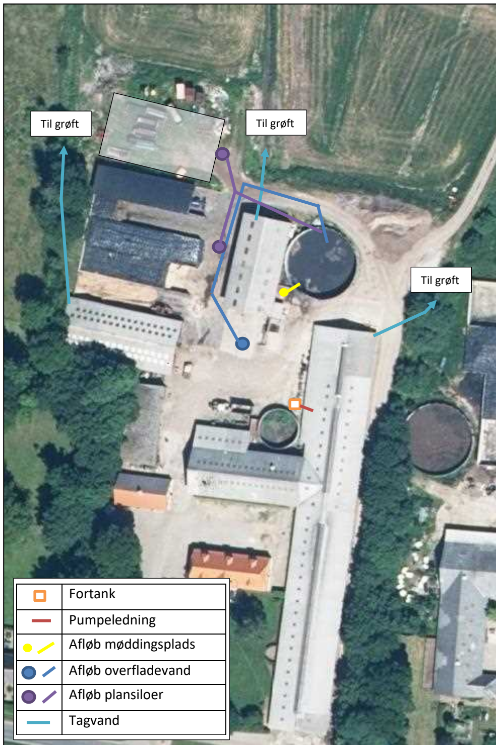
Figur 5. Afløbsplan for den nordlige del af staldanlægget
