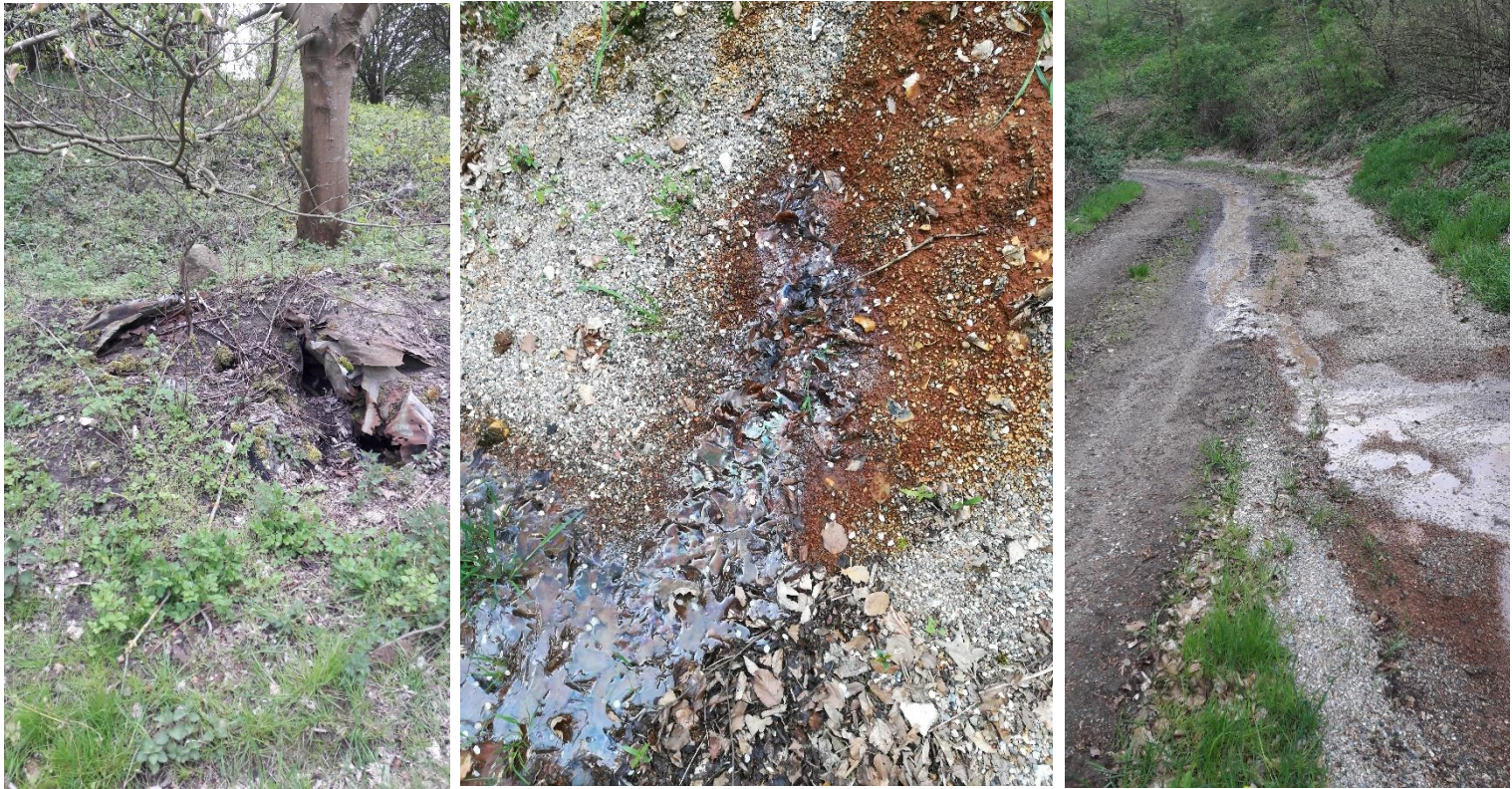
Figur.1 Billeder fra Seest Losseplads, taget på den vestlige side. Billedet til venstre viser blotlagt affald, det midterste og højre billede viser en mængde perkolat, der piplede ud fra skrænten af deponiet
