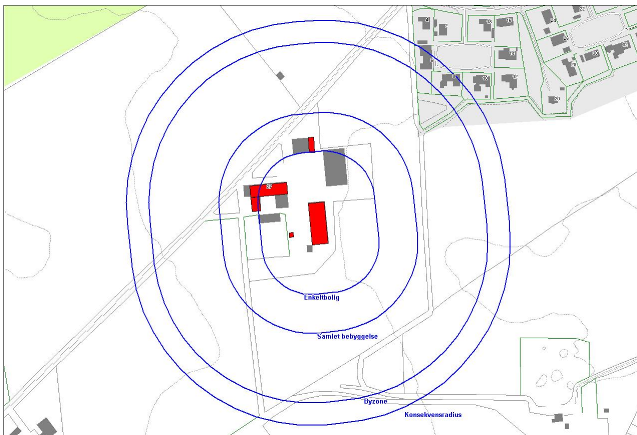
Figur 2.2: Illustrativ indtegning af anlæggets geneafstande til enkeltbolig, samlet bebyggelse og byzone. Det bemærkes at geneafstandene er tegnet som buffere rundt om hele anlægget og ikke ud fra et lugtmidtpunkt.
