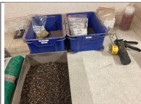
Fig. 4 Bl.a. prøver af affald, der anvendes til tilslag.
