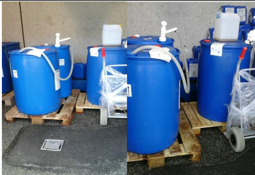
Billederne er taget i det nyetableret rum til opbevaring af rengøringsmiddel, hvor der er risiko for afløb til kloak.
