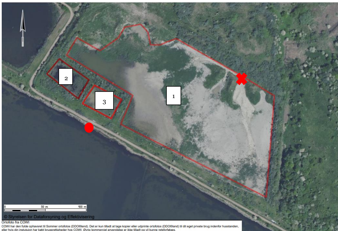
Figur 1. Opdeling af depotet, med angivelse af placering af hhv. bassin 1, bassin 2 og bassin 3. X angiver placering for den faste indspulingsledning. O angiver placering for udledningspunkt for spildevand til Karrebæk Fjord.
