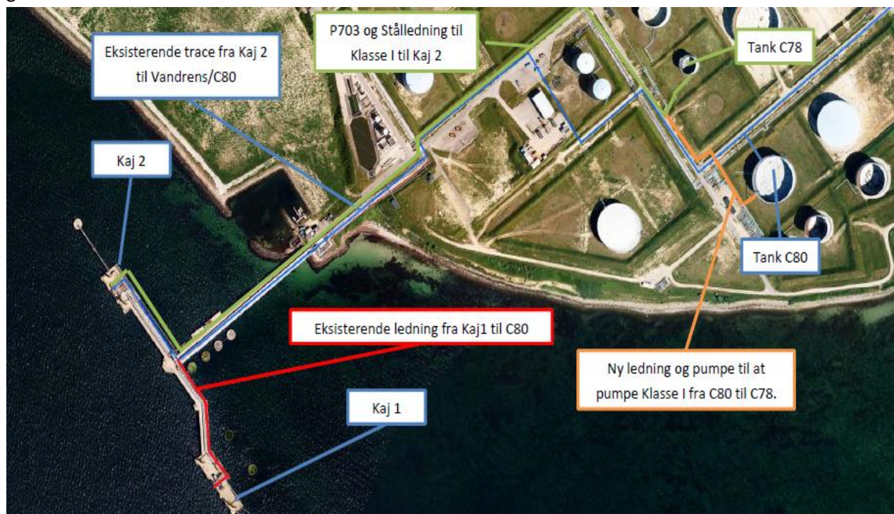
Figur 5 Oversigtskort over anvendte rørsystemer til håndtering af industrispildevand.
