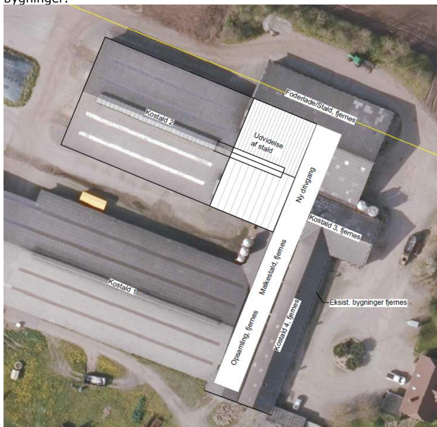
Figur 6. Overblik over renovering og nedrivning af eksisterende bygninger. Figur udarbejdet af ansøger.
