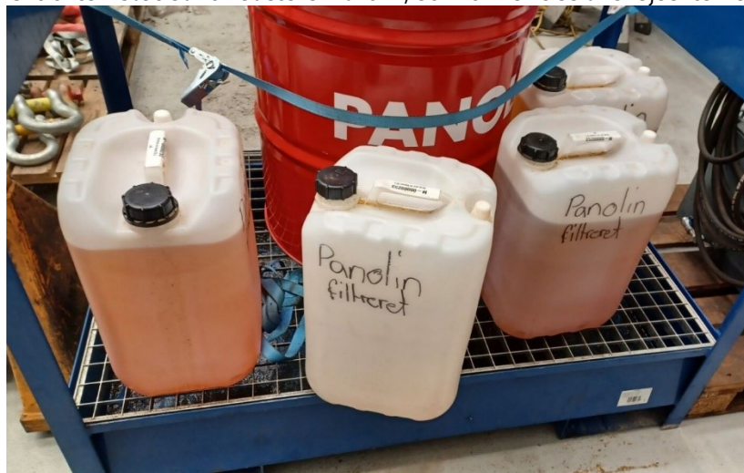
Figur 33 Kemikalier i grabværkstedet er placeret på spildbakke.
