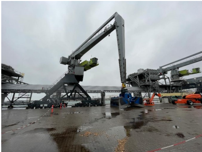
Figur 8 Kran 20 og Kran 30 på sydkajen anvendes til at losse flis fra skib.
