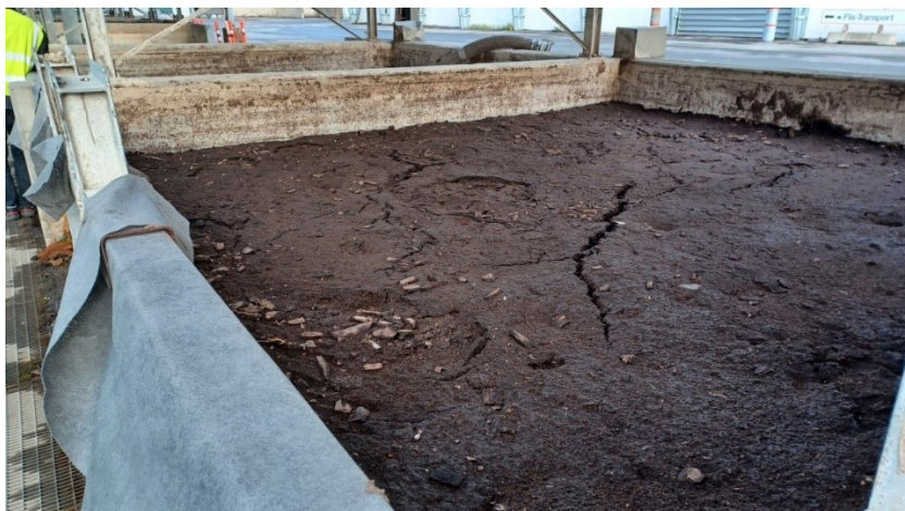
Figur 40 Fyldte geotubes tømmes over i overdækkede kar, hvor slammet tørres ind
