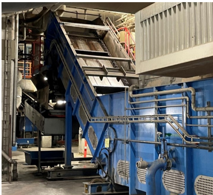
Figur 12 Slaggeudtag - Bundasken holdes våd.
