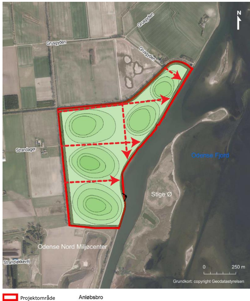
Figur 4-11 Når spulefeltets maksimale kapacitet er nået, efterbehandles området, så det kommer til at bestå af i alt fem bakke på mellem 10 og 19 meter.
