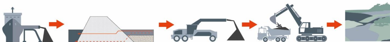
Figur 4-4 Figuren viser de forskellige aktiviteter – fra indspuling af sediment til borttransportering af nyttiggjorte fragmenter og klargøring til næste kampagne.
