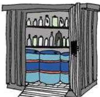
Figur 2 Udendørs opbevaring i container med dobbelt bund.
