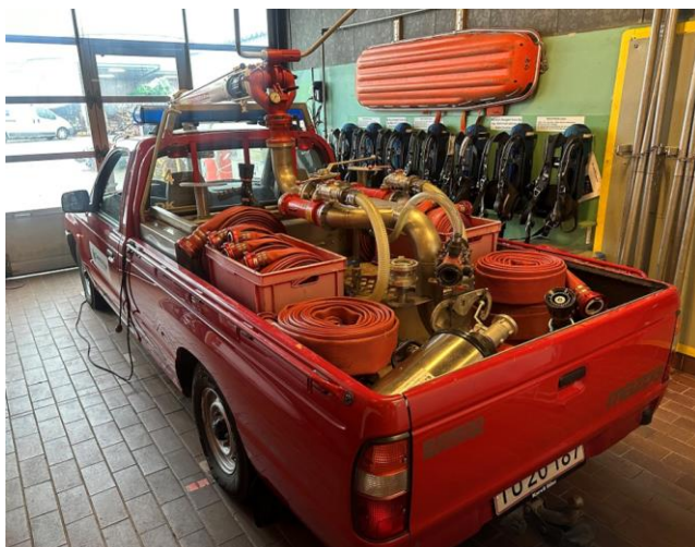
Foto 1: Mindste brandbil indeholdende brandslukningsudstyr og Stames F15 3%.
