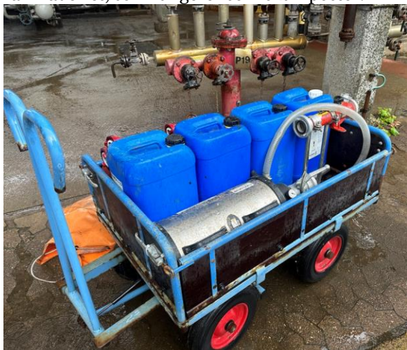
Foto 2: Trækvogn med udstyr til brandbekæmpelse.
