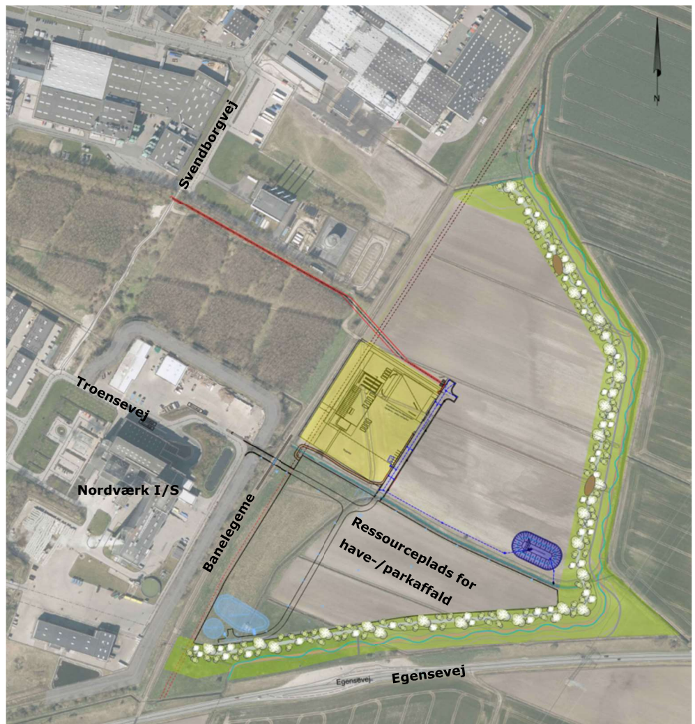
Figur 1 Angivelse af virksomhedens placering med gul. Projektområdet afgrænses af begrønnet vold ud mod Romdrup Å. Biler til- og frakører området via Nordværks arealer mod vest. Overfladevand (blå streg) ledes til regnvandsbassin mod sydøst. Spildevand (rød streg) pumpes til spildevandsledning i Svendborgvej mod nordvest. Målestok 1:2000.
