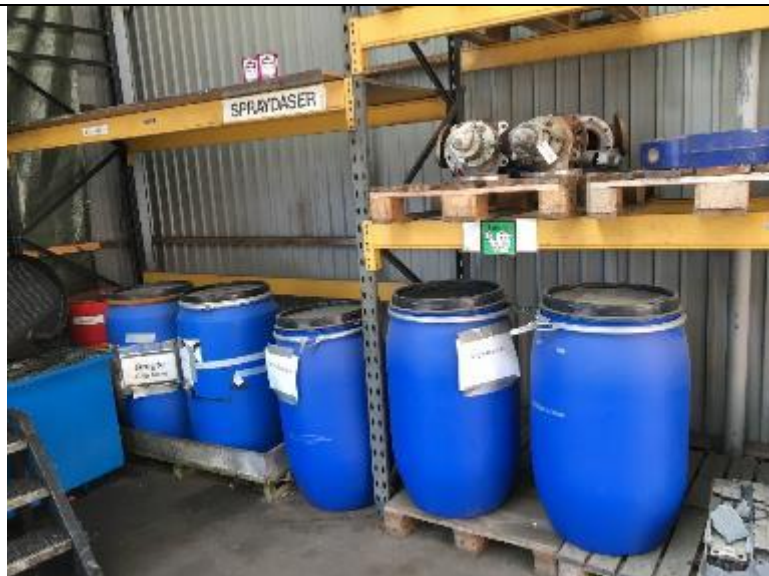
Oplag af brugte batterier og olieklude i spændefade under halvtag.
