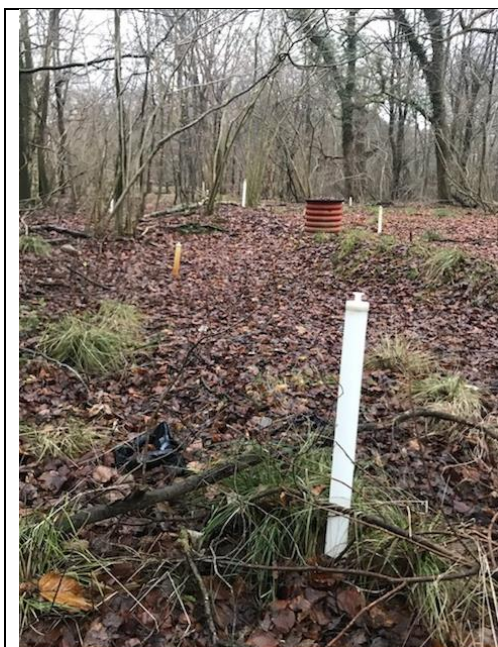
Fig. 3 Monitoringsboringer i forbindelse med infiltrationsforsøg.
