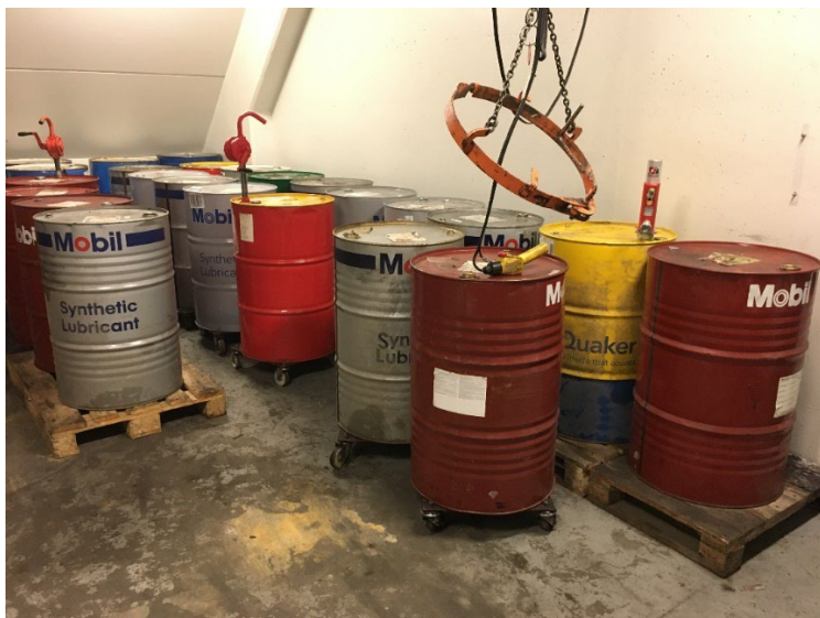
Figur 8. Forbrugsfade hævet over gulv. Løftværktøjet er for at sætte fyldte fade på rulleplade, så de er lette at flytte i rummet for aftapning.
