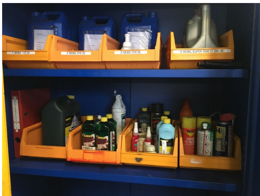
Figur 4. Eksempel på opbevaring af produkter i små beholdere/tuber, der ikke udgør nogen risiko for væsentlig jord- og grundvandsforurening.
