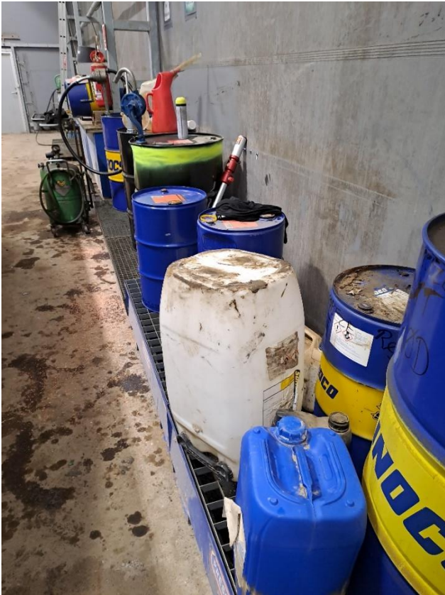
Billede 3: Beholdere til reparation i telthallen. Korrekt placeret på spildbakker.
