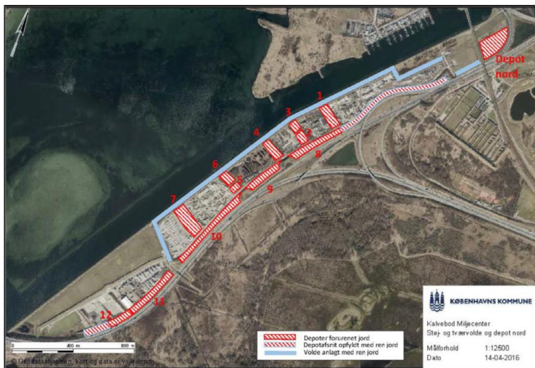
Figur 1. Opdeling af område for støjvolde, tværvolde og depot for forurennet jord.
