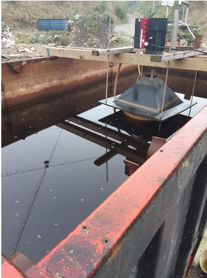
Afsluttet forsøg med forrensning af perkolat.
