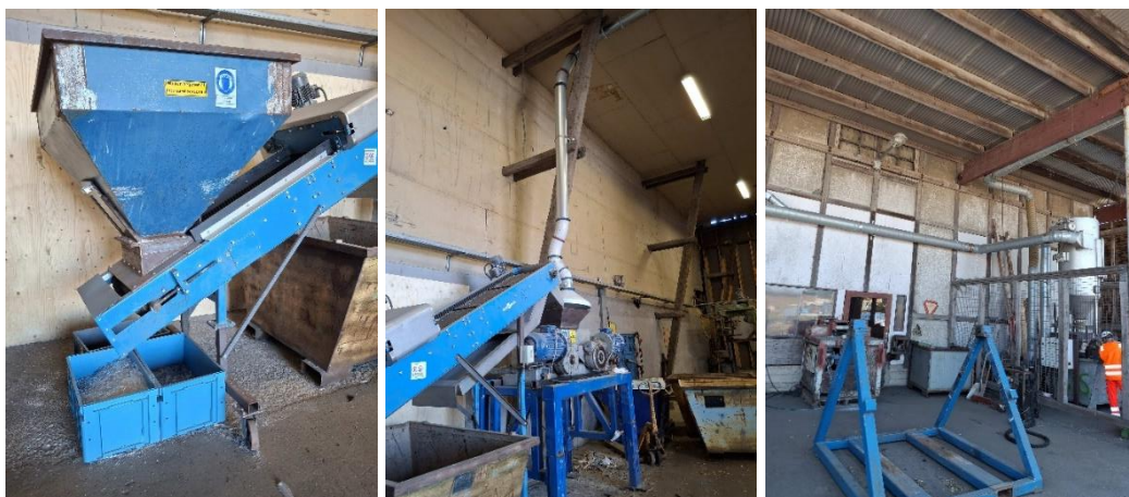
Medical glasknusanlæg med afkast der er koblet sammen med afkast fra Cables M16-kabelklipper, til højre ses filteranlæg
