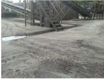
Fig. 5 Vandfyldt opsamlingsrende langs konturen af blegejordspladsen
