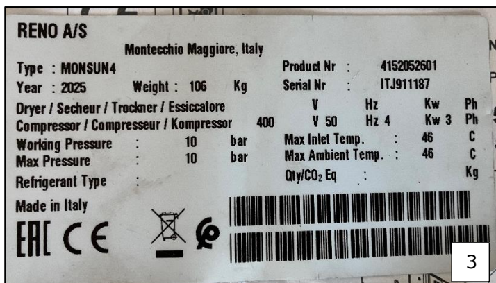
Foto 3 og 4: Mærkeplade for kompressor og placering midt i et af værkstedslokalerne indendørs
