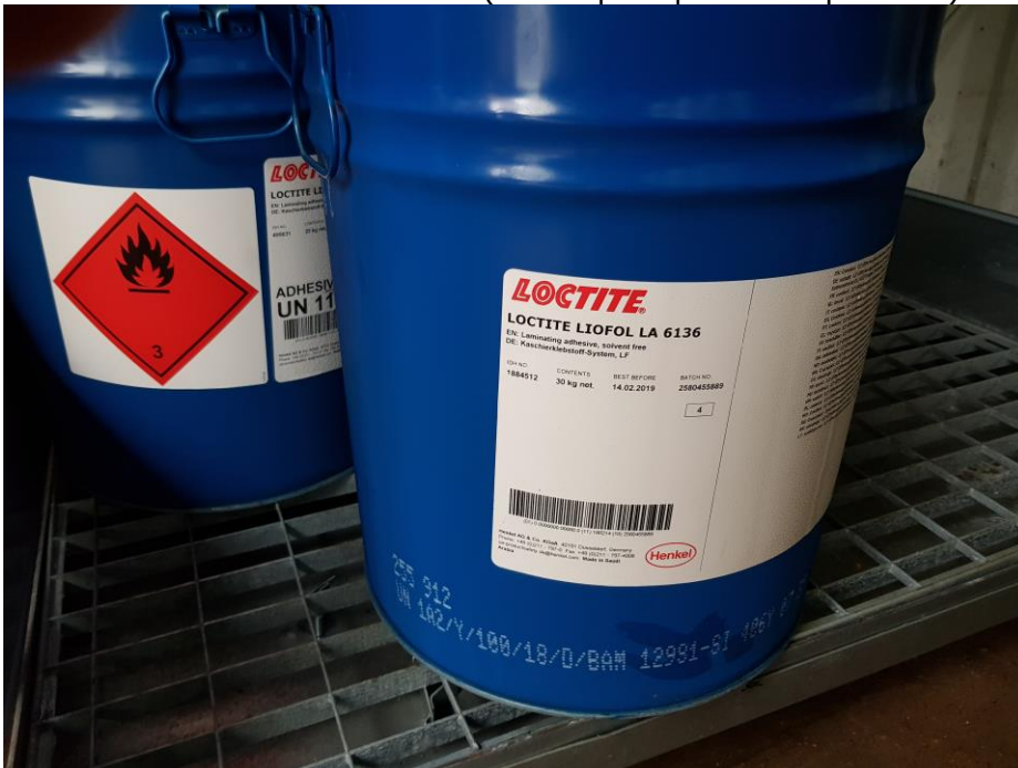
Billede 4 Kemikalier i kemi container (indsækpelse på for lille spildbakke)
